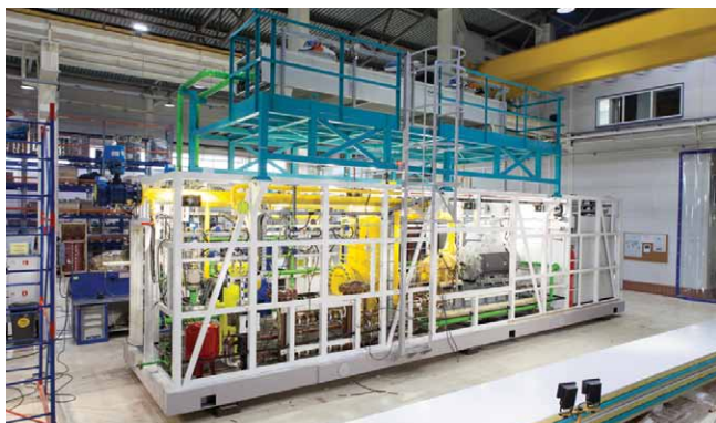
Дожимная компрессорная станция ГЕА в процессе изготовления, производственная площадка, г. Климовск
