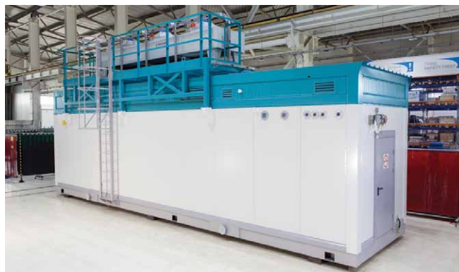
Дожимная компрессорная станция ГЕА, производственная площадка, г. Климовск
